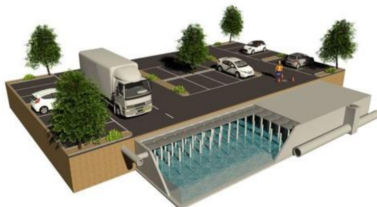
Figuur 4 Ondergrondse waterberging (Watershell) (Wissink, 2019)
